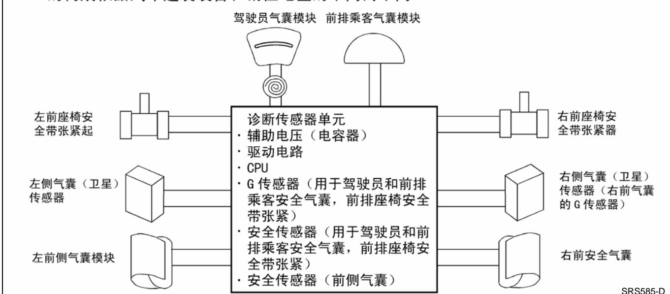
当点火开关在ON或START位置时, 如果诊断传感器单元激活, 气囊将引爆。
